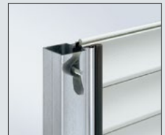
Classic 卷帘门 标配带钢质防风钩结构的侧堵 (订货宽度大于 5000 mm 时标配或尺寸较小但需要更高抗风压性能时选配)
